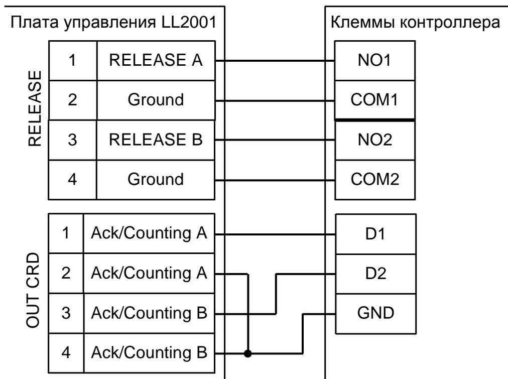
Рисунок 102. Подключение турникетов Gunnebo с платой управления LL2001.
