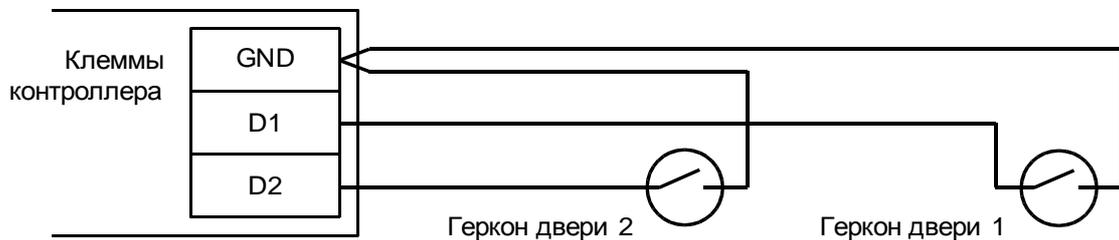
Рисунок 28. Подключение датчиков открытия дверей.
