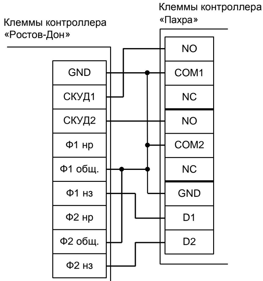
**Рисунок 81. Подключение турникетов и калиток «Ростов–Дон», новая электроника, вариант №2.**
