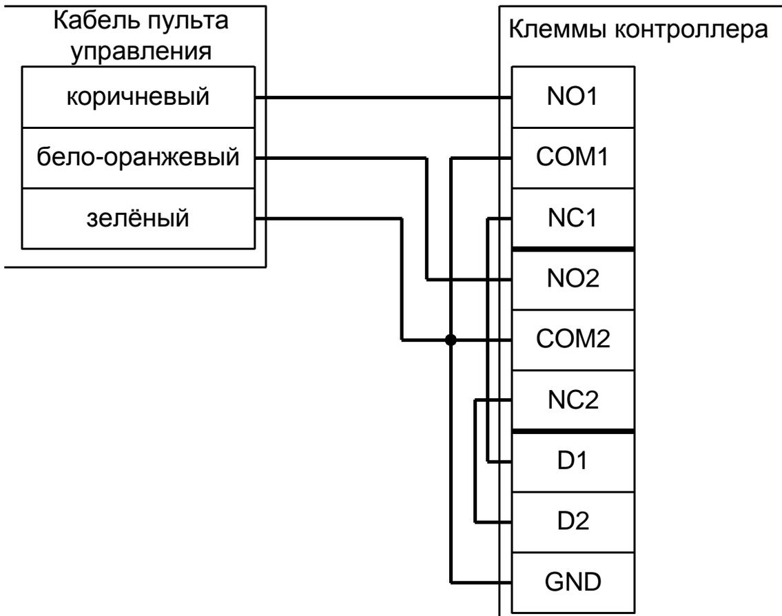
Рисунок 88. Подключение автоматических калиток «Ростов–Дон», новый вариант.
