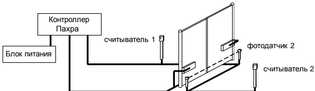
Рисунок 125. Пример автоматизации ворот с использованием прокси-карт или меток.
