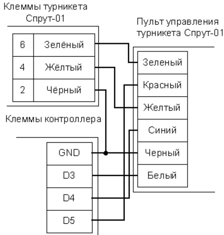
Рисунок 113. Первый вариант подключения пульта управления турникета «Спрут-01».
