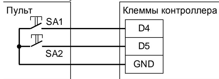
Рисунок 126. Подключение пульта ручного управления воротами, вариант №1.
