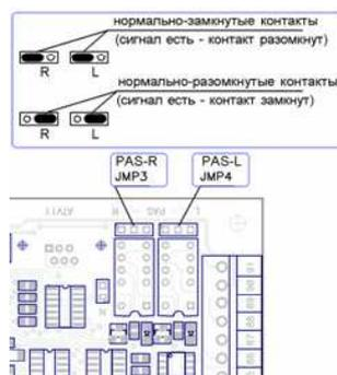
Рисунок 74. Перемычки JMP3 и JMP4 контроллера ОМА 264MC1.
