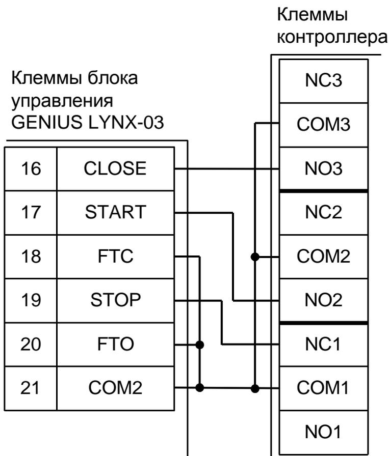
Рисунок 163. Подключение к блоку управления LYNX-03.
