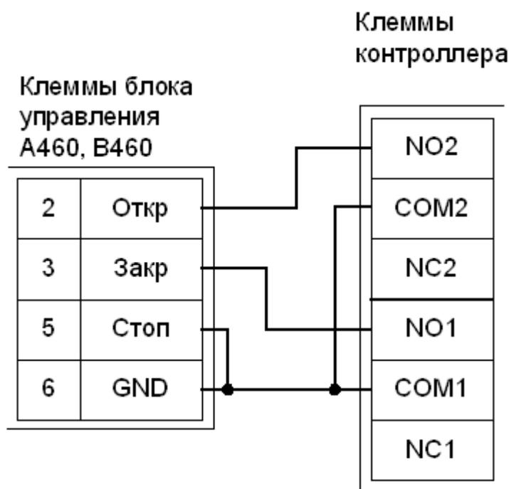
Рисунок 167. Подключение блоков управления Normann А460, В460.
