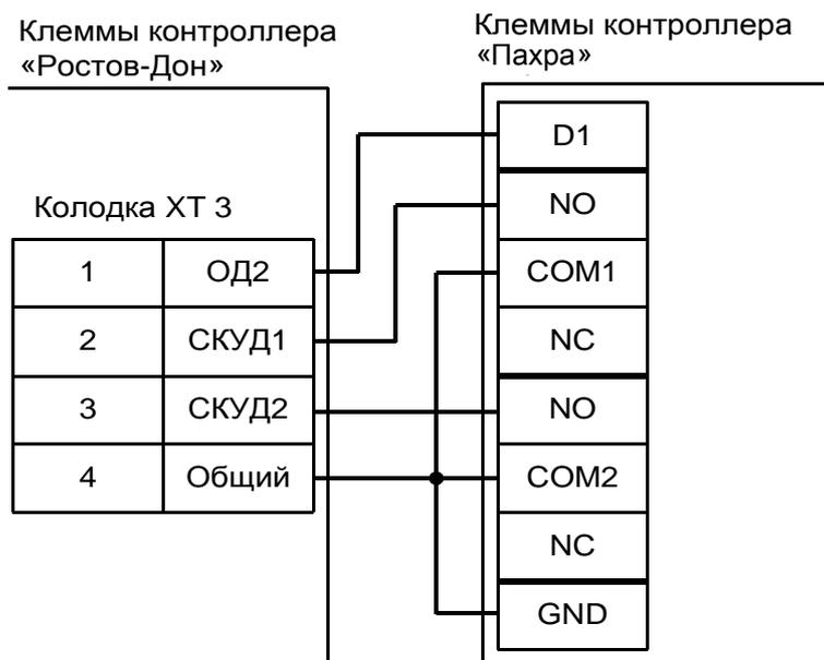
Рисунок 82. Подключение турникетов и калиток «Ростов–Дон», старая электроника, вариант №1.
