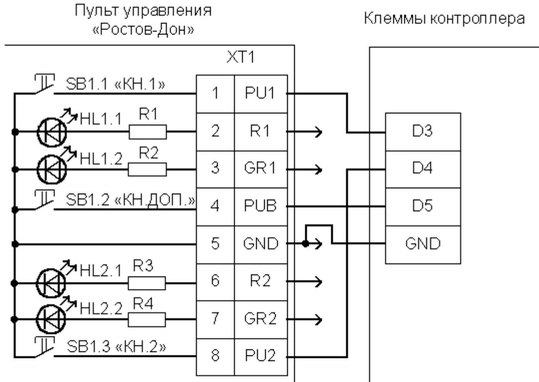
**Рисунок 86. Подключение пульта управления Ростов–Дон, старая электроника.**
