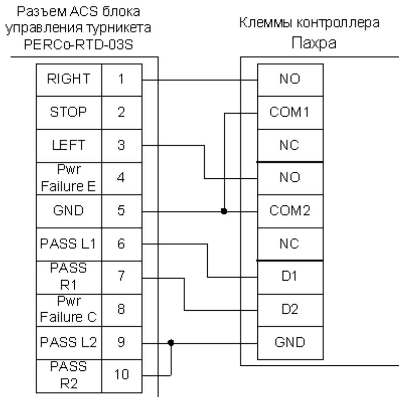
Рисунок 54. Подключение турникета PERCo-RTD-03S.
