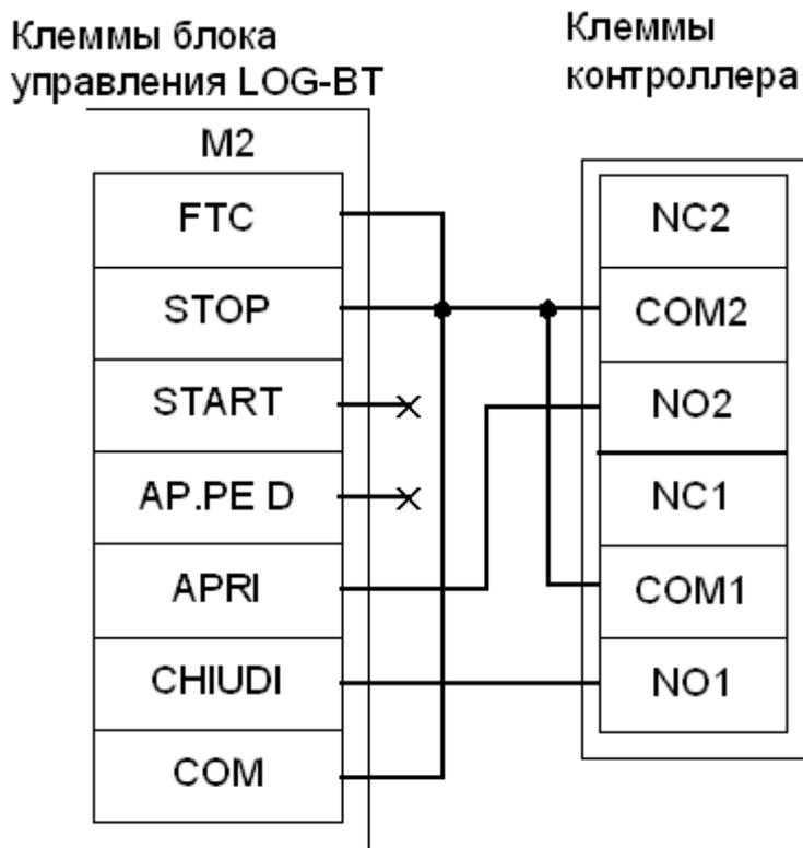
Рисунок 168. Подключение блока управления LOG-BT.
