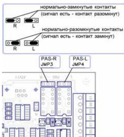
Рисунок 69. Перемычки JMP3 и JMP4 контроллера ОМА–DD.958, ОМА 264МС1.
