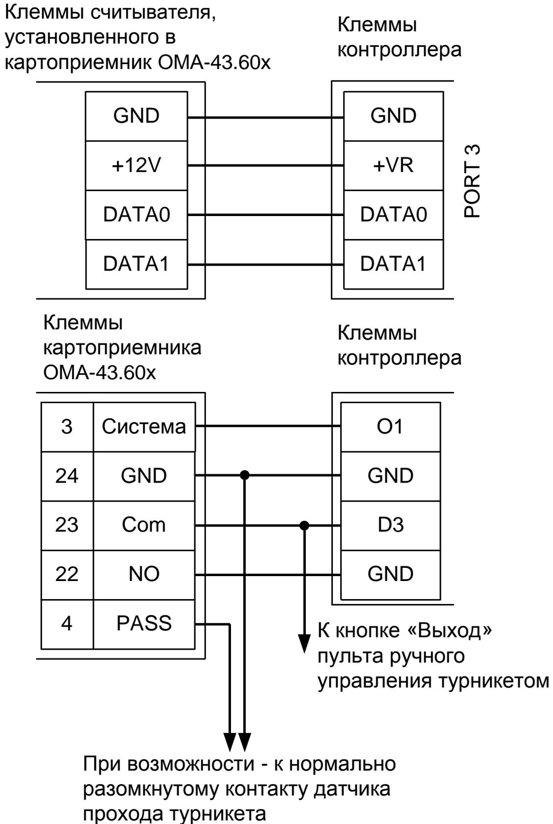
Рисунок 36. Пример подключения картоприёмника ОМА-43.60х в направлении «выход».
