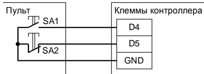
Кнопка «Стоп» нормально замкнута, переключатель №5 дип-блока CONF1 - в положении ON.
