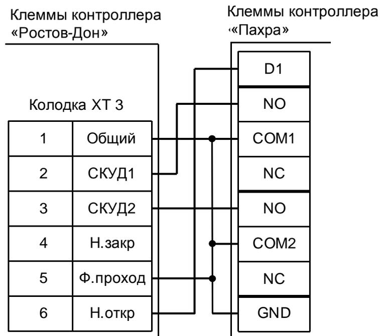
Рисунок 85. Подключение турникетов и калиток «Ростов–Дон», старая электроника, вариант №4.
