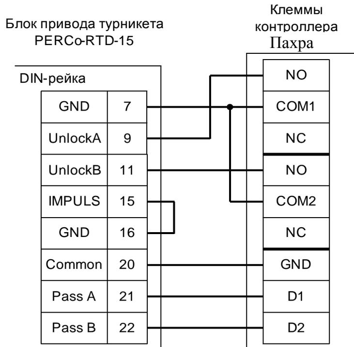
Рисунок 55. Подключение турникета PERCo-RTD-15.
