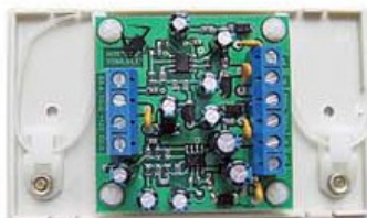
Рисунок 18 – Устройство подключения видеодомофона
