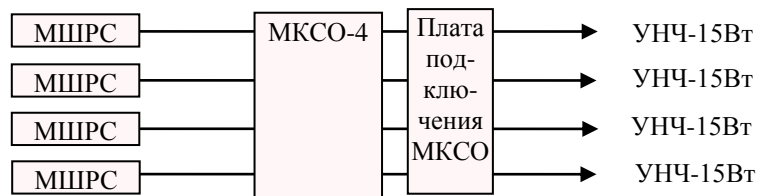
а) 4 адресных канала оповещения
