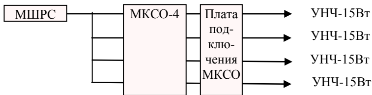
б) 4 канала оповещения с одним адресом
