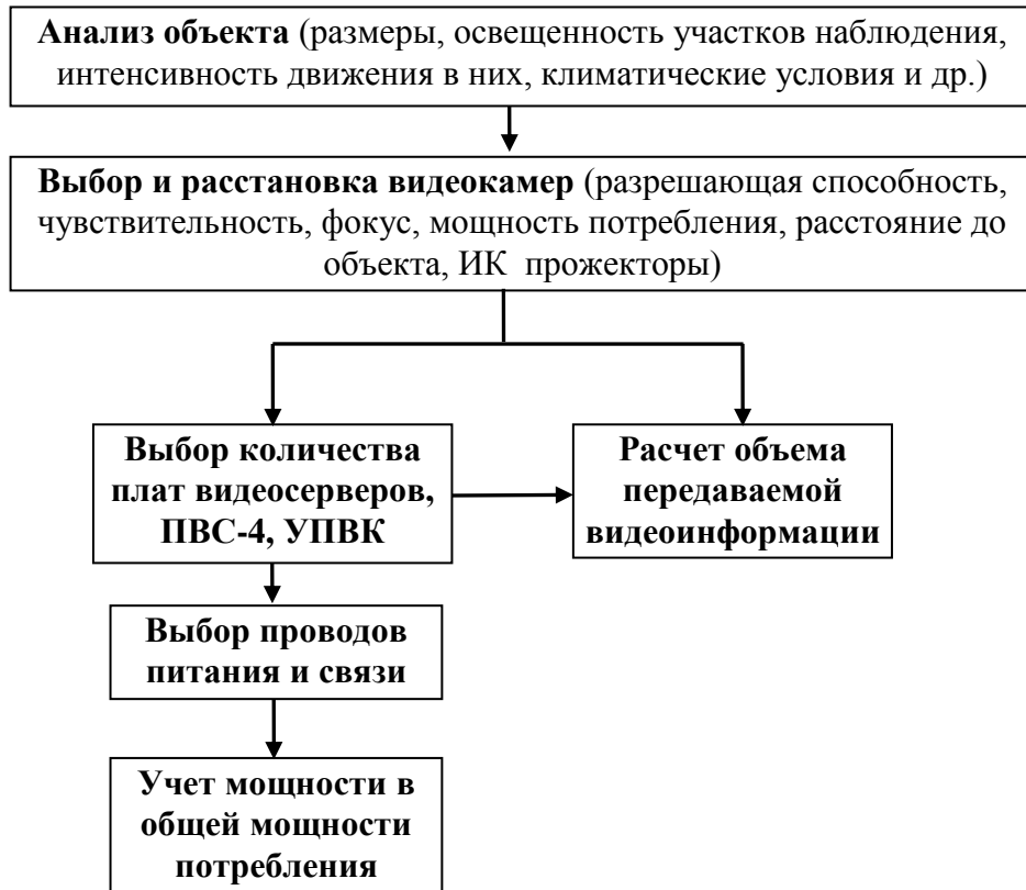
Рисунок 8.2 Алгоритм построения видеосистемы.
