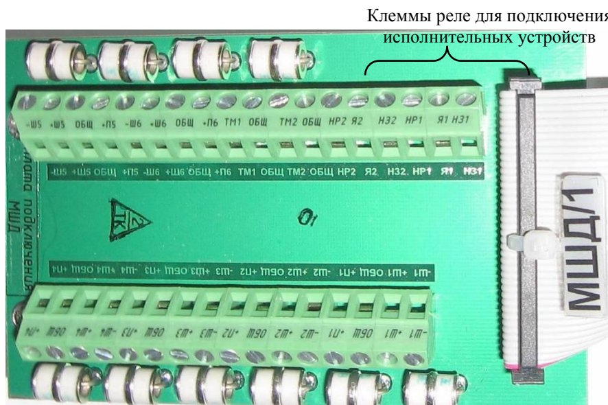
Рисунок 13.1 Подключение исполнительных устройств к СЛУП
