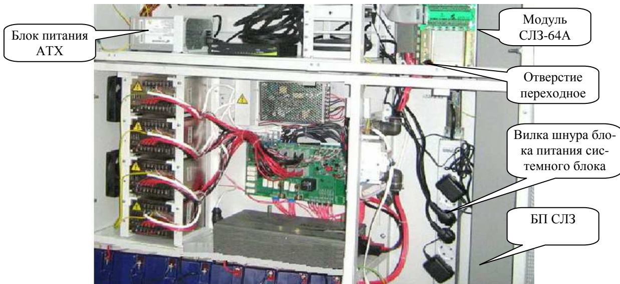
Рисунок 7.3. Подключение питания системного блока.
