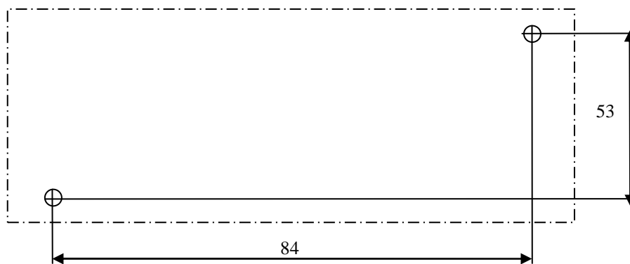
Рисунок 9.4. Разметка крепления корпуса УПВК-03П исп.2
