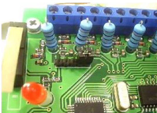
Рисунок 12. Установка джампера для аппаратного сброса адреса.
