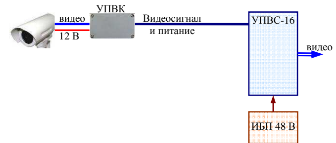
Рисунок 1.1. Схема применения УПВК в комплекте с устройством приёма видеосигналов УПВС-16
