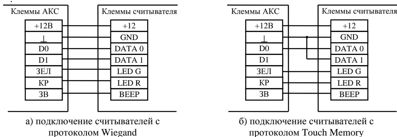
Рисунок 5.14. Подключение считывателя
