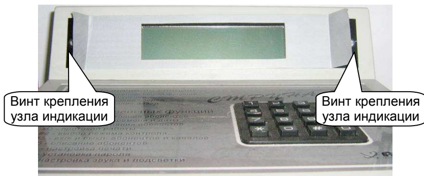
Рисунок 7. Доступ к винтам крепления узла индикации
