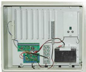
**Ретранслятор РТ-М** Предназначен для приёма извещений от объектовых устройств (до 160 шт.), работающих в протоколе «Струна-М, 3М», обработки, формирования и передачи сообщений о состоянии охраняемых объектов. Контролирует 2 шлейфа пожарно-охранной сигнализации и целостность корпуса. Обеспечивает санкционированный доступ на объект. Имеет встроенный источник бесперебойного питания. Обеспечивает двухстороннюю связь с ретранслятором РСПИ Радиосеть™
